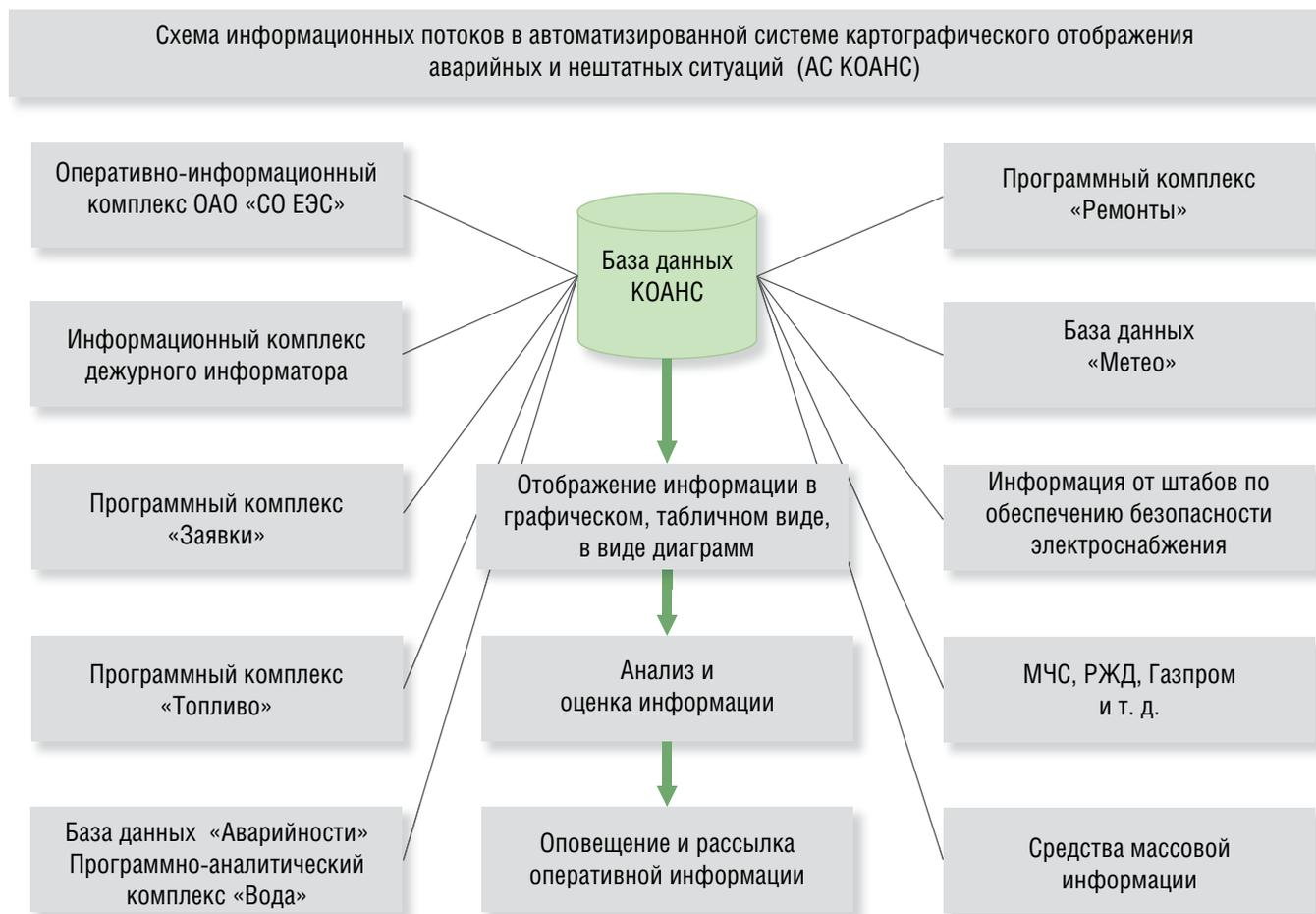
Рис. 2. Функциональная схема автоматизированной системы картографического отображения аварийных и штатных ситуаций
