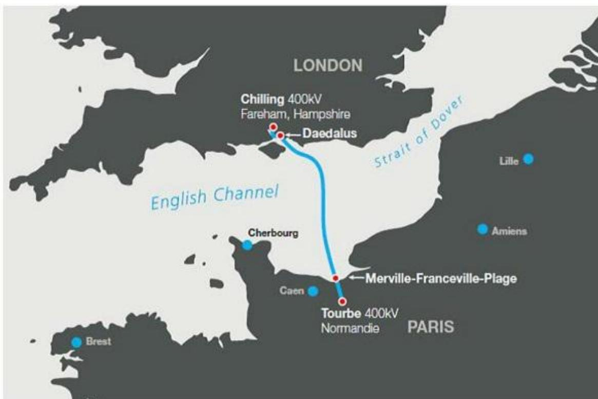
В местах выхода кабеля на берег – в коммуне Merville-Franceville во Франции и в районе Daedalus в Великобритании – будут сооружены две преобразовательные подстанции (ППС) по технологии HVDC light на базе VSC инверторов<sup>2</sup>. Оборудование для ППС, а также подводный и наземный кабели, будут изготовлены шведско-швейцарским концерном ABB и итальянской компанией-производителем кабеля Prysmian.
