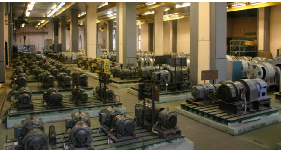
Электродинамическая модель энергосистемы состоит из более тысячи единиц физических моделей оборудования. Машинный зал ЭДМ
