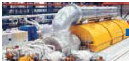
Турбогенераторы с паровой или газовой турбиной
