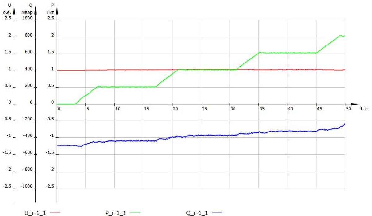
**Рис. Д.35. Пример корректной работы АРВ сильного действия синхронного генератора (плавного входа в зону ОМВ) в статическом режиме при медленном увеличении активной мощности генератора**
