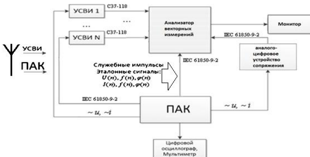
Рисунок 1. Тестовая схема для проведения сертификационных испытаний УСВИ
