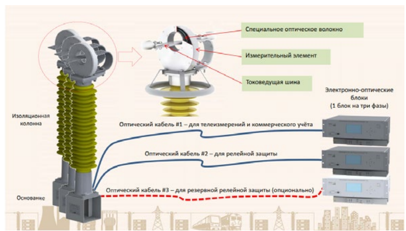
Конструкция ТТЭО (цифрового ТТ)
