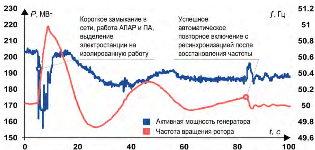
Пример переходного процесса при аварийном возмущении с быстрозатухающими колебаниями частоты и мощности благодаря корректировке алгоритмов САР турбин
