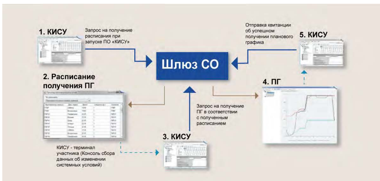
Схема взаимодействия при автоматическом доведении плановых графиков через систему MODES
