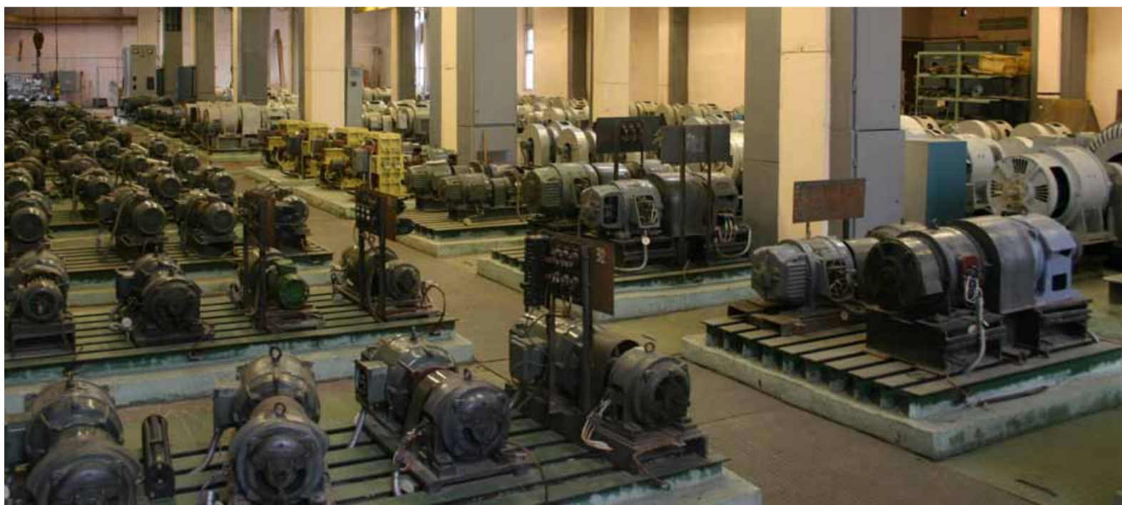
Машинный зал электродинамической модели энергосистемы
