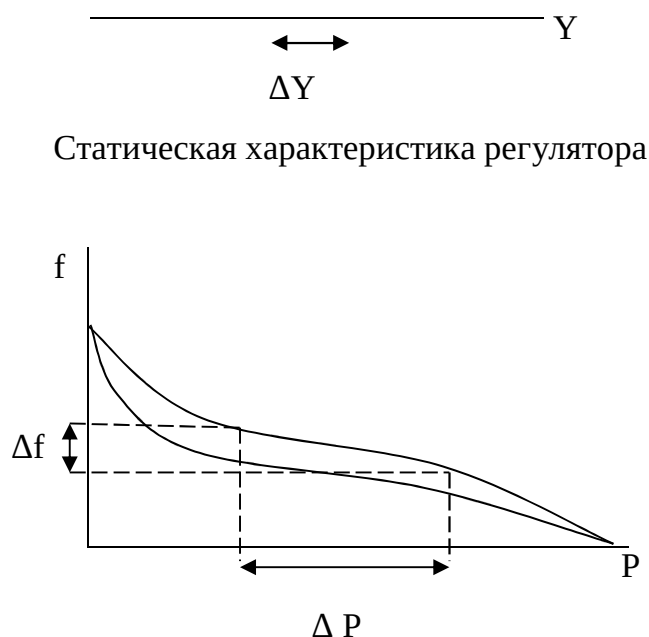
Рис. 2 Статическая характеристика системы регулирования
