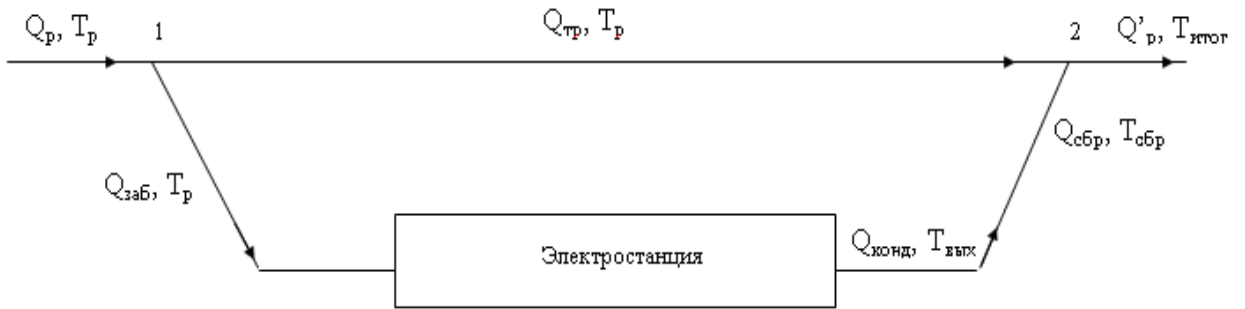
Рис. 11.9. Принципиальная схема технического водоснабжения
