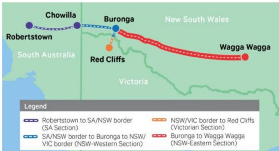
HVAC-соединение EnergyConnect 330 кВ пропускной способностью 800 МВт и протяженностью 900 км – от ПС Вагга-Вагга на юго-западе Нового Южного Уэльса до ПС Роберстаун в Южной Австралии (с ответвлением от ПС Буронга до ПС Ред Клиффс в штате Виктория) – свяжет энергосистемы штатов Южная
