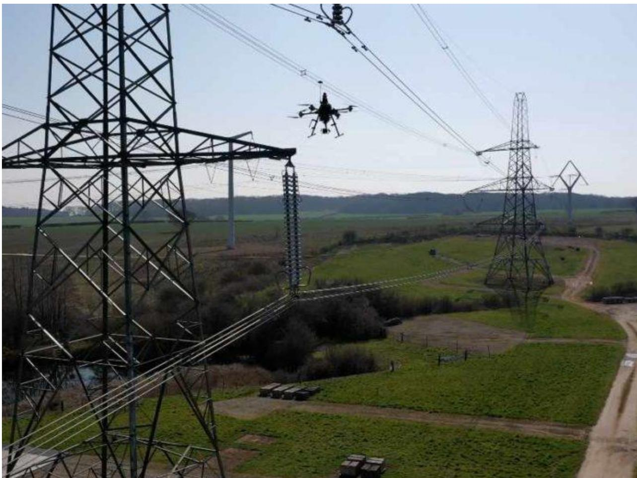
NGET в настоящее время отвечает за техническое состояние 21 900 стальных решетчатых опор ЛЭП в Англии и Уэльсе. Ежегодно NGET осуществляется инспекция состояния стальных конструкций около 3 650 опор путем съемки цветных изображений в высоком разрешении, получаемых с помощью вертолетов и дронов с ручным управлением.
