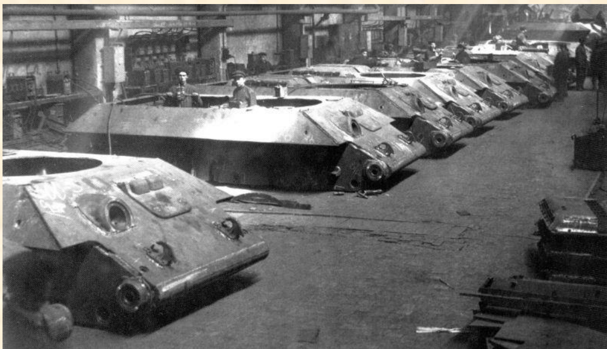
Сварка корпусов на заводе №183. 1942 г.
