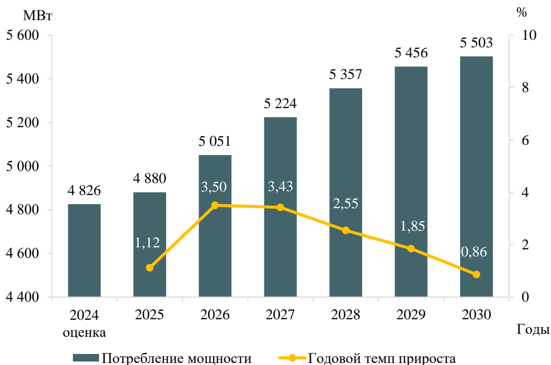
Рисунок 9 – Прогноз потребления мощности Краснодарского края (в зимний период) и годовые темпы прироста
