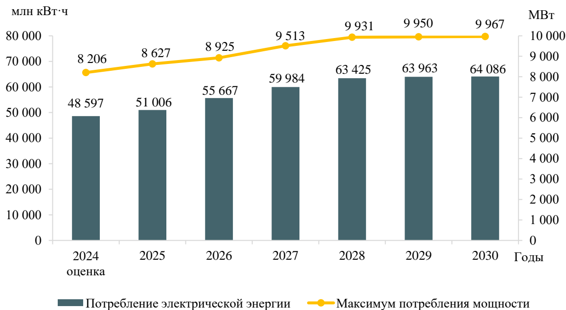
Рисунок 18 – Прогнозные значения показателей потребления электрической энергии и мощности 2-й синхронной зоны ЕЭС России
