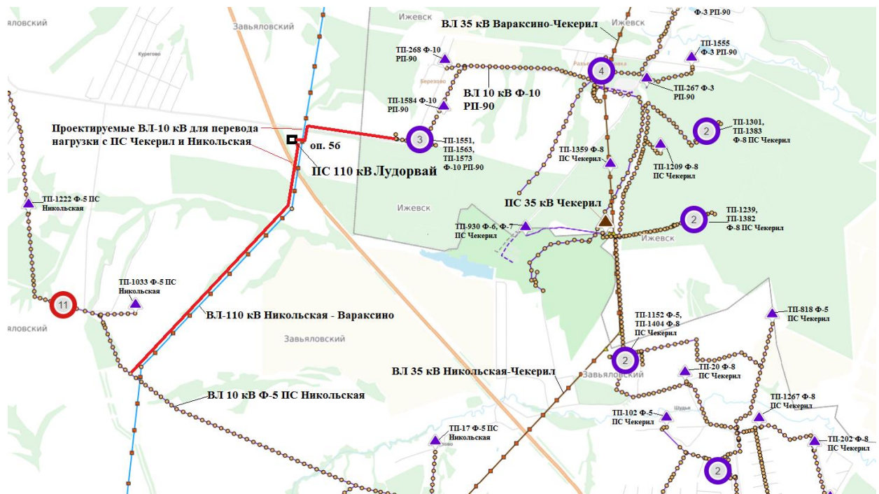
Рисунок 3 – Схема расположения новой ПС 110 кВ Лудорвай
