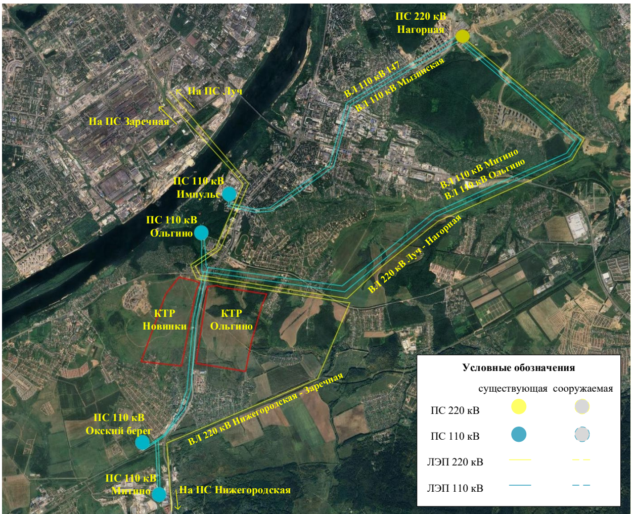
Рисунок 5 – Карта-схема электрических сетей района размещения потребителей КРТ Новинки, КРТ Ольгино
