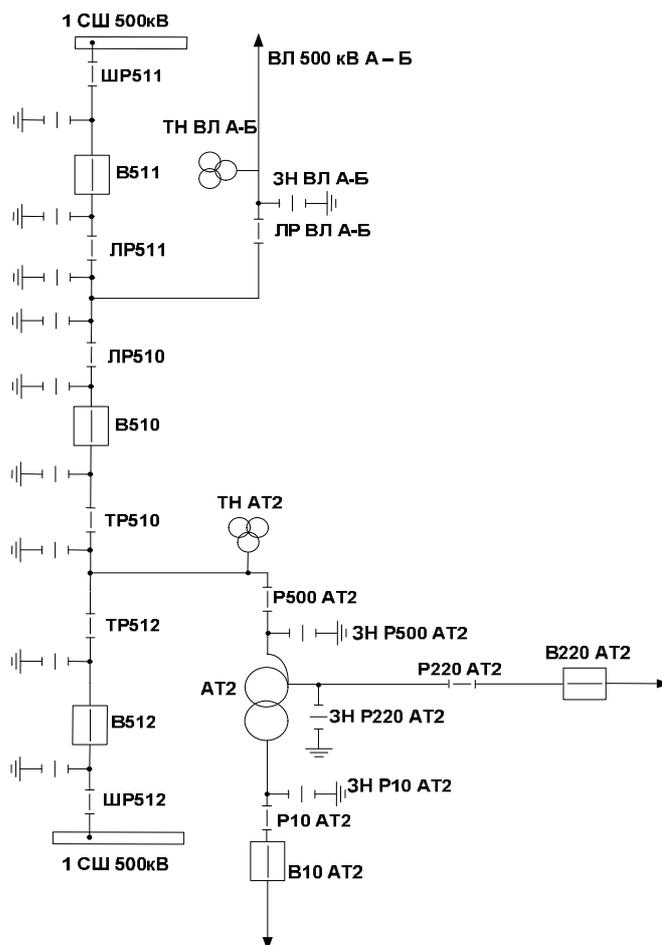
Рис. 8. Схема ПС 500 кВ, выполненная по полуторной схеме
