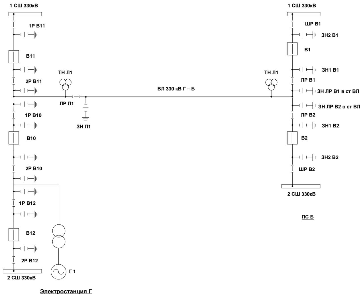
Рис. 5. Схема подключения ВЛ 330 кВ Г – Б
