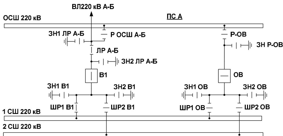
Рис. 10. Схема РУ с двумя рабочими системами шин и обходной
