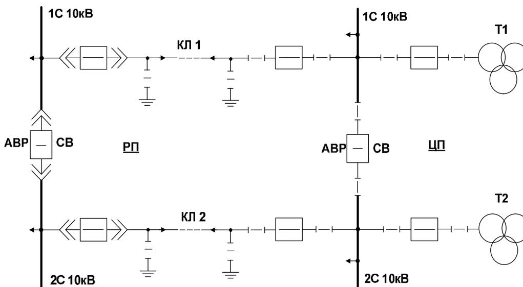
Рис. 12. Схема участка распределительной сети 6-10 кВ
