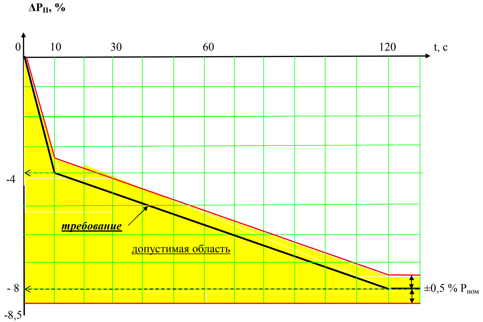
Рис. П.1. Допустимая область изменения первичной мощности энергоблока при \Delta P_{II} = -8\% P_{ном} при скачкообразном повышении частоты
