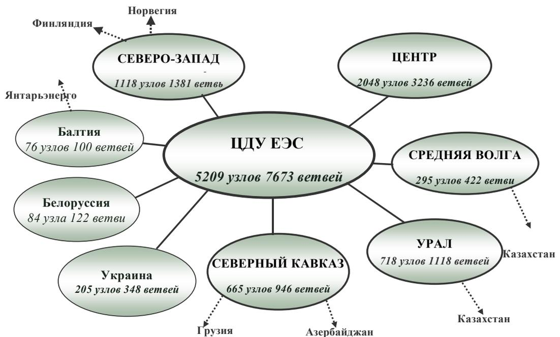
Рис. 5.1. Единая расчетная схема Европейской части ЕЭС России
