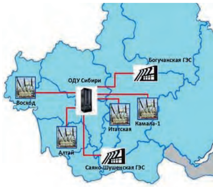
Структурная схема ЦСПА ОДУ Сибири
