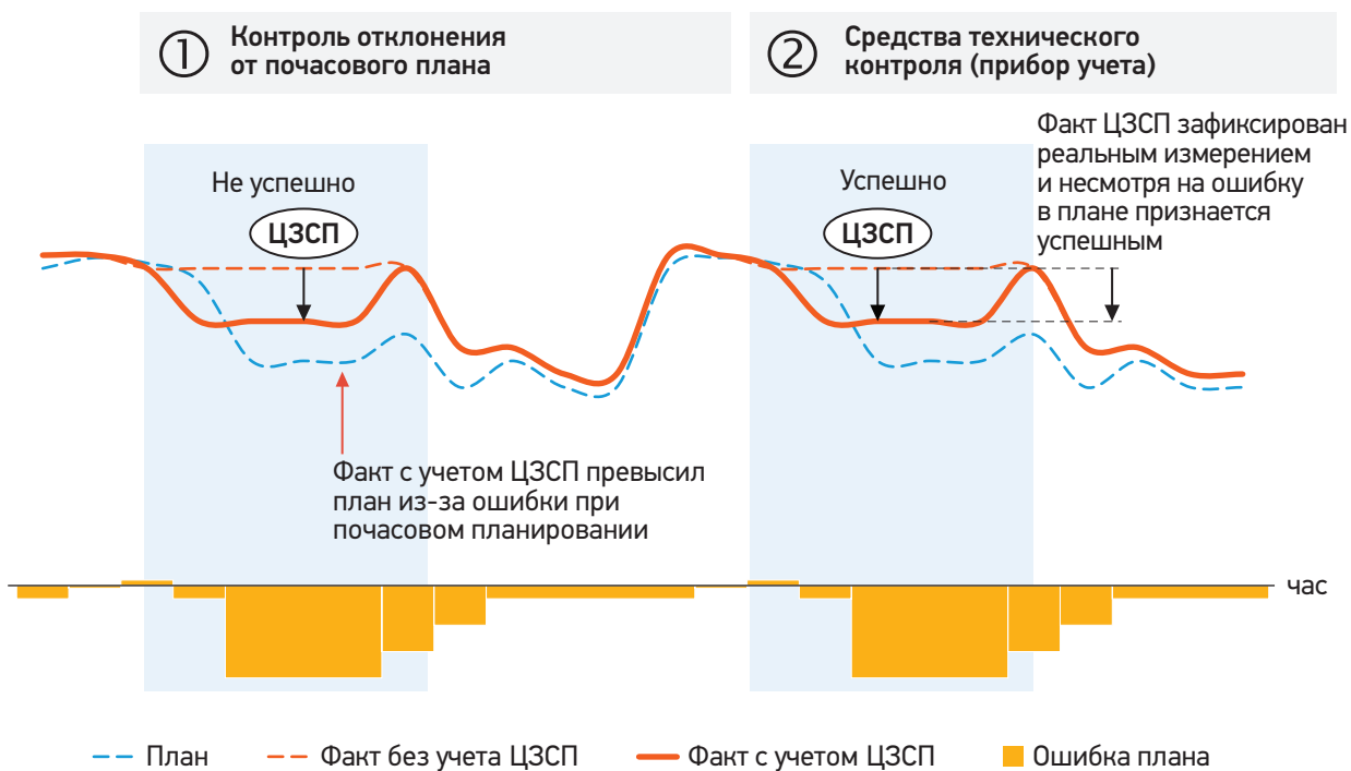
Рис. 30. Пример разных методов контроля одного события ЦЗСП, МВт
