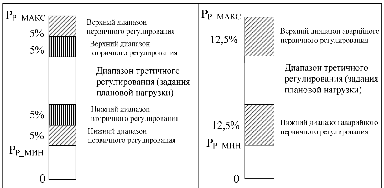
Рис. 4.6. Размещение диапазонов регулирования
